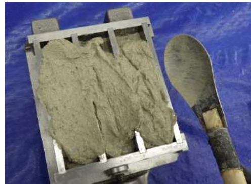
モルタル充填後
