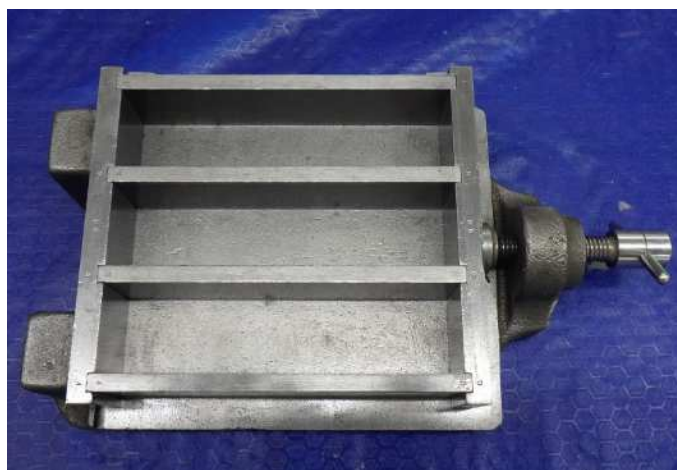
角柱供試体の型枠
