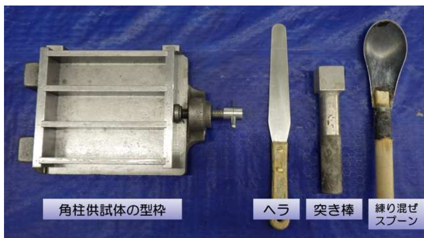
角柱供試体の型枠
