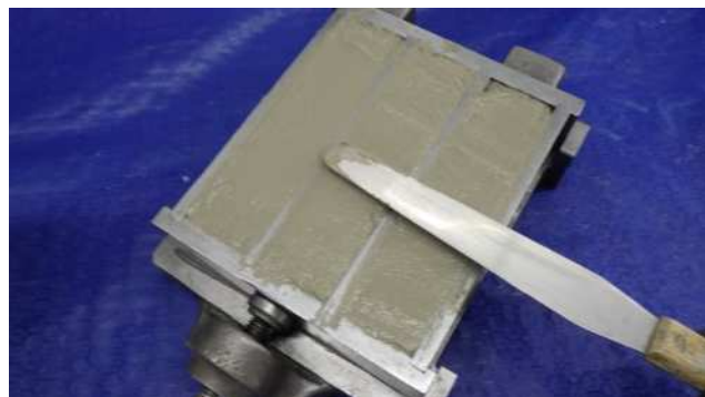
モルタル除去状況
